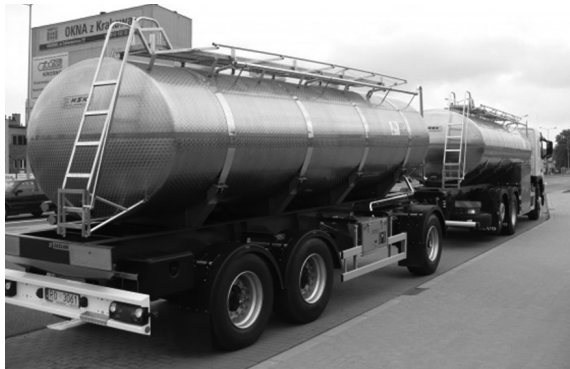
Figure 7. Three-axle tanker – trailer with elliptical section Rysunek 7. Cysterna trzyosiowa – przyczepa o przekroju eliptycznym Source: [WSK „PZL – KROSNO” S.A.]
