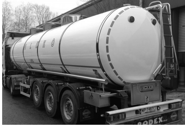
Figure 2. Tank (capacity 26,000 l), with a wheeled section on a self-supporting semi-trailer Rysunek 2. Zbiornik (pojemność 26 000 l), z częścią kołową na naczepie samonośnej Source: [WSK „PZL – KROSNO” S.A.]
