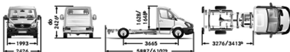
Rysunek 2. Wymiary samochodu mercedes sprinter, typ podwozie do zabudowy z rozstawem osi 3665 mm
